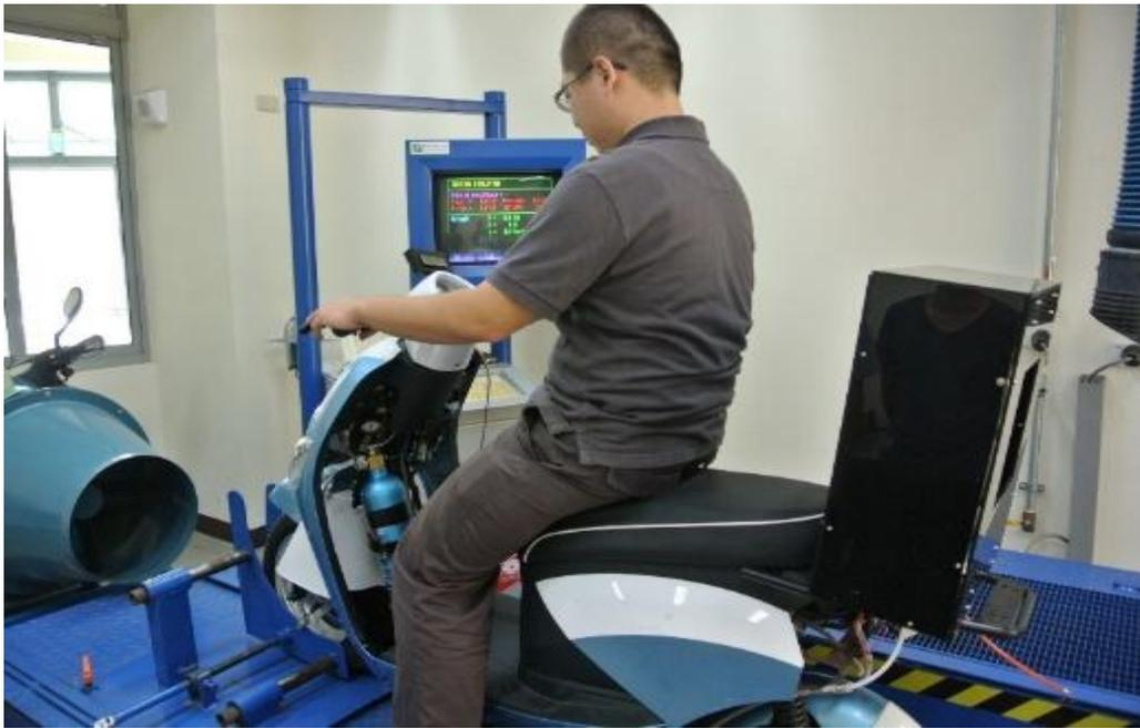
圖 5 最高速度測試
