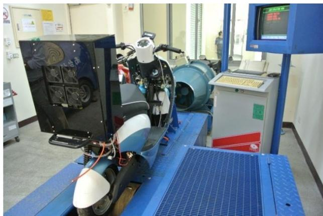
圖 4 動力測試平台
