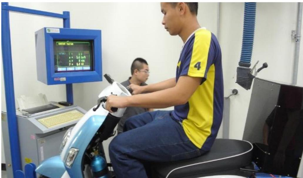
圖 6 爬坡能力測試
