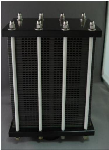
圖 1 待測試燃料電池堆
